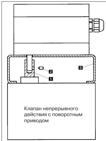
Рис. 18. Монтаж позиционера на клапан непрерывного действия с поворотным приводом
